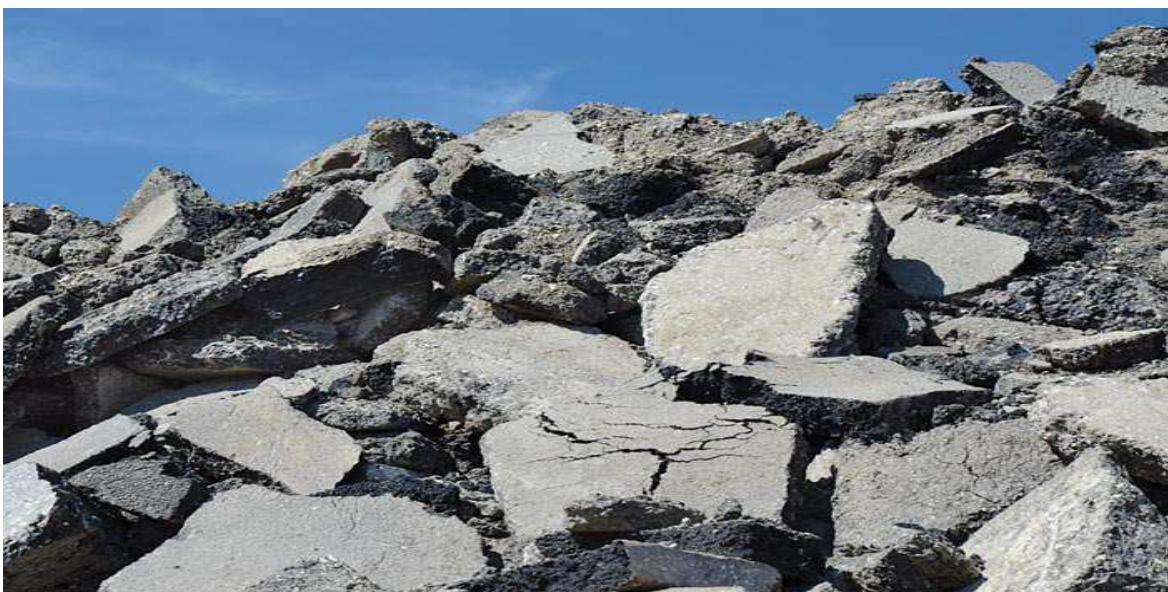
Abb. 9 Zur Aufbereitung zwischengelagerter Straßenaufbruch in Schollenform Quelle © Wikipedia
