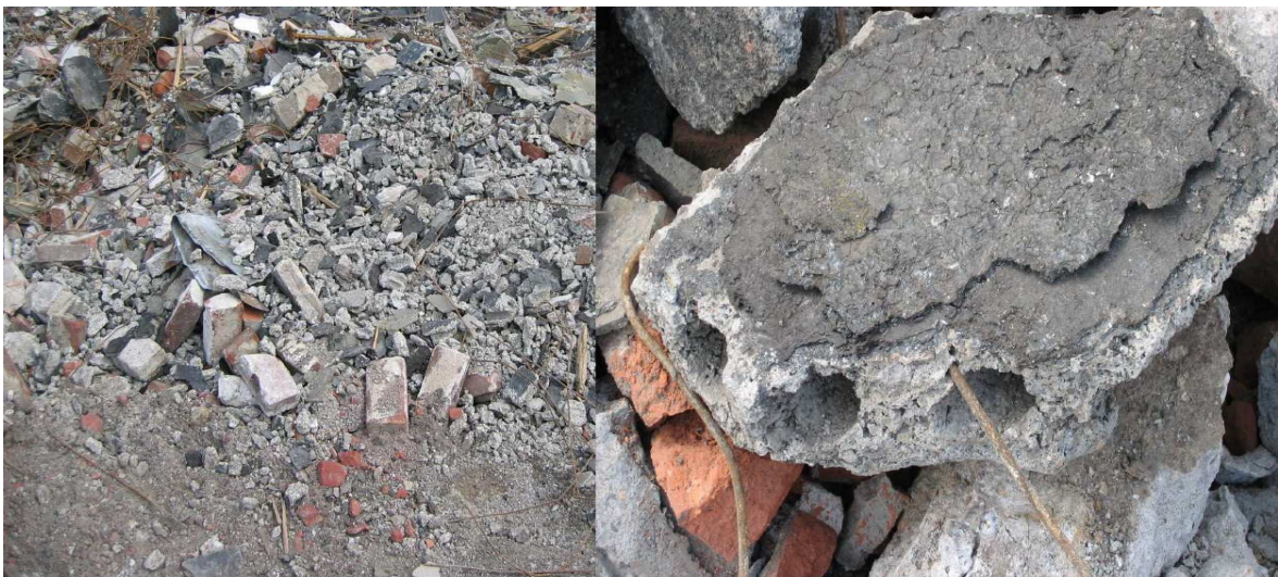
Abb. 10 Asbestzement + PAK belastete Baustoffe sind von unbelasteten Baustoffen kaum zu unterscheiden.
